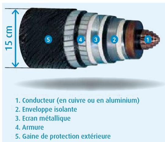
Figure 8 - Coupe schématique d'un câble sous-marin (source RTE)
